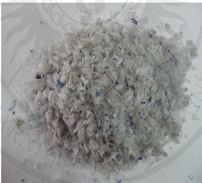
ภาพประกอบ 46 การย่อยพลาสติกชนิด Polyethylene, PE ที่ความเร็วรอบ 864 รอบต่อนาที
