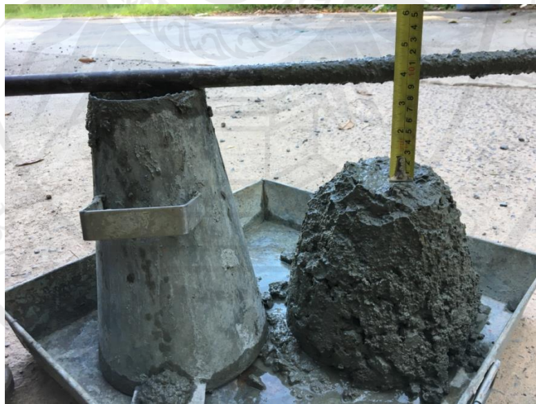
ภาพประกอบ จ.2 การทดสอบค่ายุบตัวของคอนกรีต
