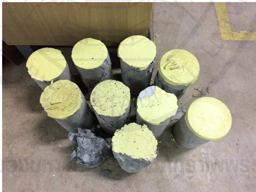
ภาพประกอบ ฉ.4 คอนกรีตที่ผ่านการทดสอบแล้ว
