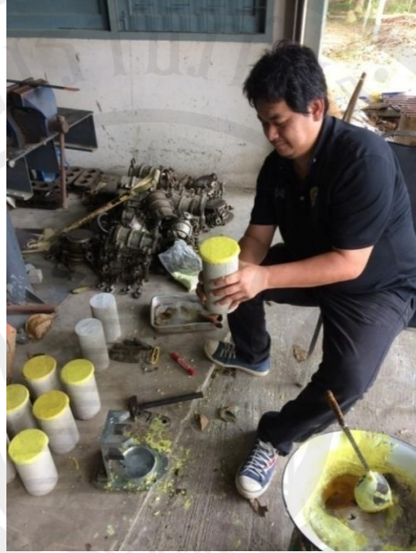
ภาพประกอบ จ.5 การแคปหัวคอนกรีตด้วยกำมะถัน
