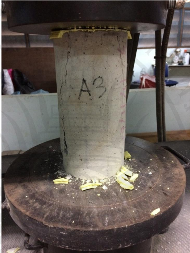
ภาพประกอบ ฉ.3 การทดสอบแรงอัดคอนกรีตรูปทรงกระบอก
