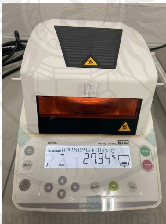
ภาพภาคผนวก 9 เครื่องวัดปริมาณความชื้น (Moisture Analyzer) ยี่ห้อ SHIMADZU รุ่น MOC63u
