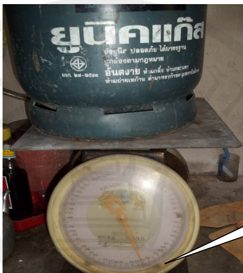
รูปภาพที่ 24 แสดงการชั่งน้ำหนักก๊าซหุงต้มหลังการใช้งานเหลือ 27.1 กก.
