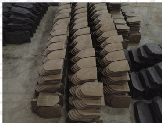
ภาพประกอบ 13 การนำแผ่นกระเบื้องมาเรียงแล้วนำไปเข้าเตาเผา
