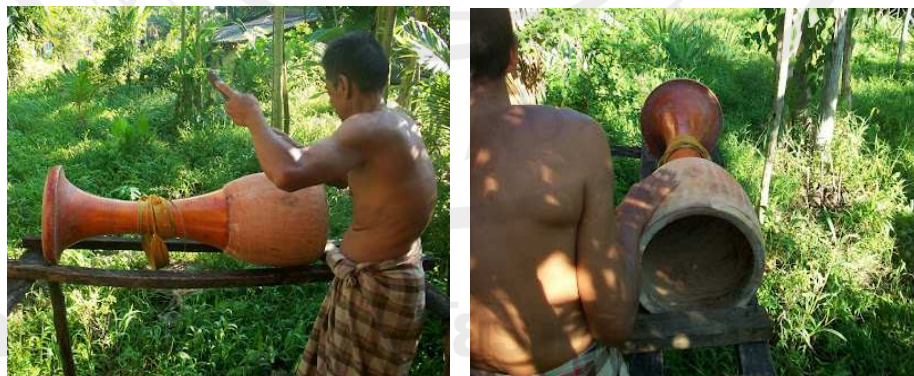
ภาพประกอบ 22 นำมาเกลา และตากให้เป็นรูปทรงกลองยาว
