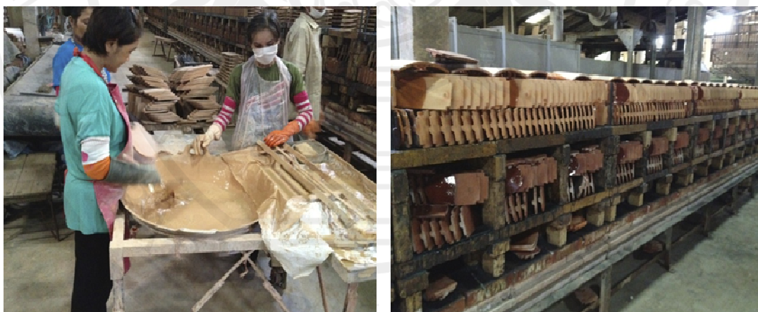
ภาพประกอบ 15 การข้อมสีและเผาเข้าเครื่องอัดโนมตี
