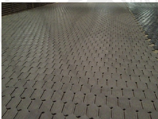
ภาพประกอบ 13 การนำแผ่นกระเบื้องมาเรียงแล้วนำไปเข้าเตาเผา
