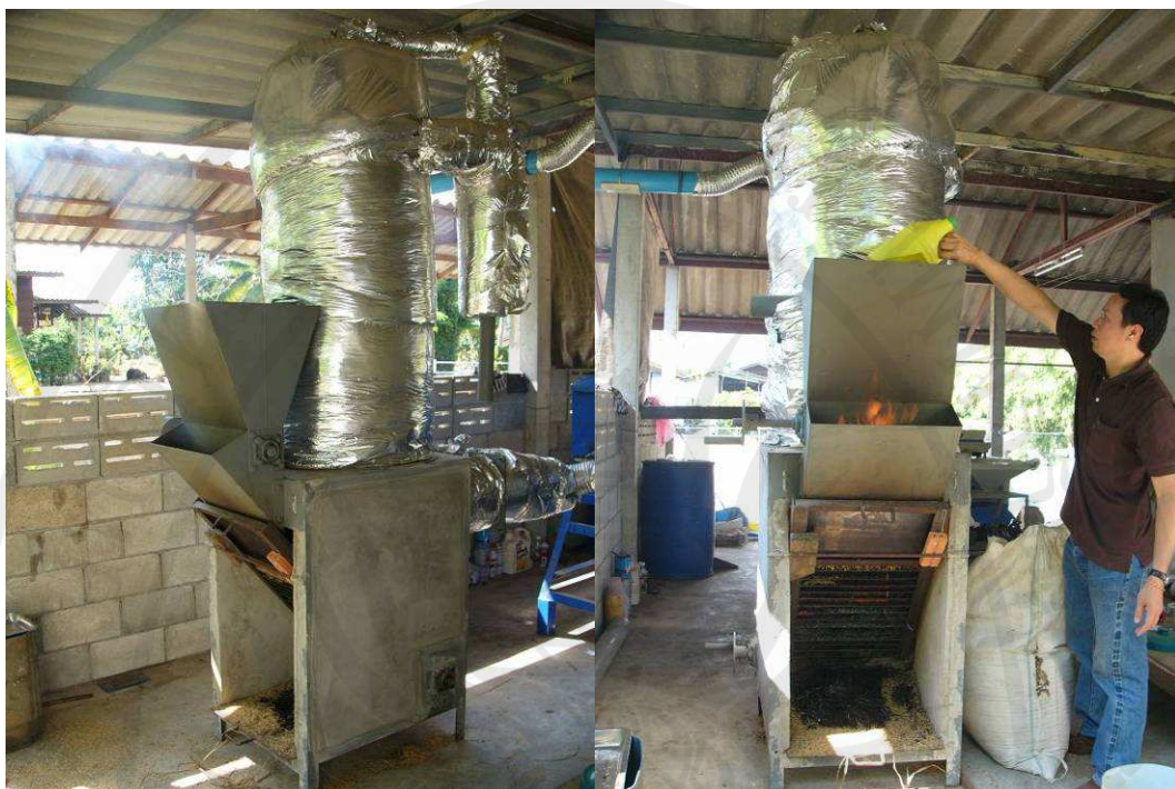
ภาพประกอบ 27 ทดสอบเตาเผาแกลบแบบแบบตะกรับผสมกับเตาแบบไซโคลนที่สร้างขึ้น
