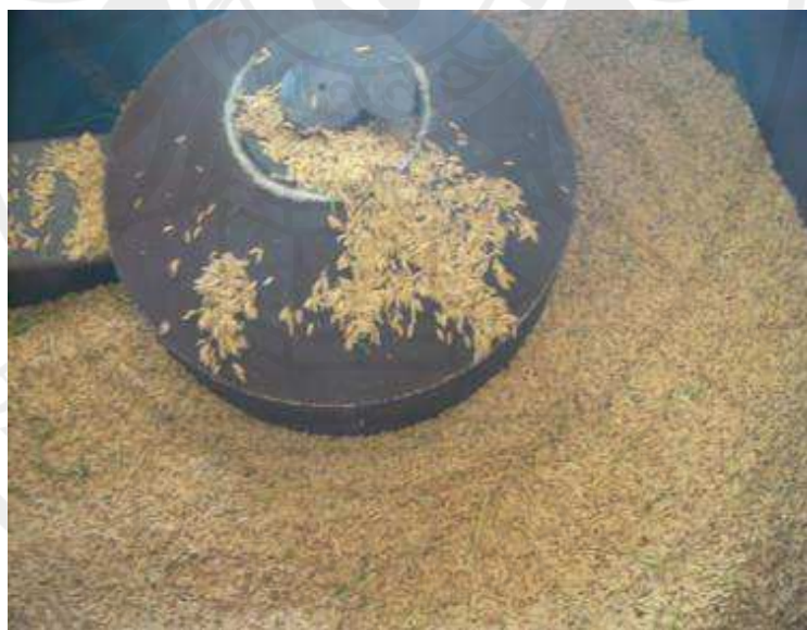
ภาพประกอบ 36 การทำงานเครื่องอบแห้งข้าวเปลือกแบบถังหมุนเวียนแลกเปลี่ยนความร้อนของข้าวเปลือกและลมร้อนจากเตาเผาแกลบ
