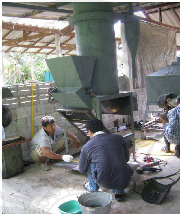
ภาพประกอบ 17 เตาเผาแลกเปลี่ยนแบบตะกรับผสมกับเตาแบบไซโคลนที่สร้างขึ้น
