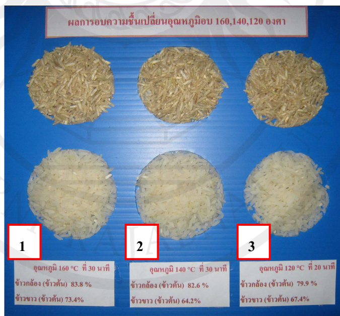
ภาพประกอบ 51 ผลการอบความชื้นเปลี่ยนอุณหภูมิอบ 160, 140, 120 องศาเซลเซียส
