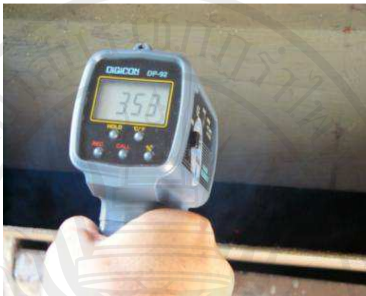
ภาพประกอบ 33 การวัดค่าความร้อนขณะกลบใหม่ โดยใช้เครื่องมือวัดแบบเลเซอร์ 35.3 °C
