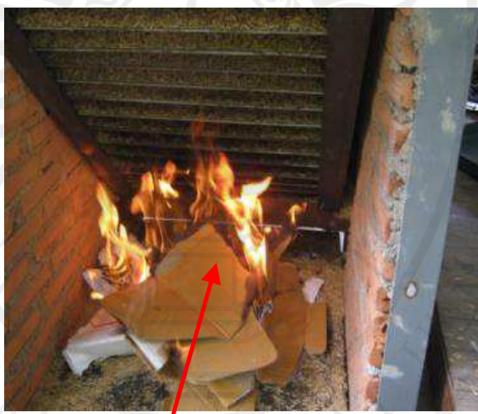
ภาพประกอบ 30 ลักษณะการจุดเชื้อเพลิงเพื่อเผาแกลบ โดยใช้กระดาษเป็นเชื้อเพลิง
