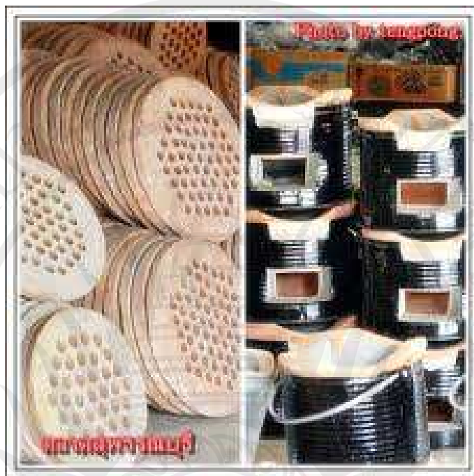
ภาพประกอบ 13 ตะกรับสำหรับใช้กับเตาอั้งโล่ ที่มา : Tengpong. ออนไลน์. 2553
