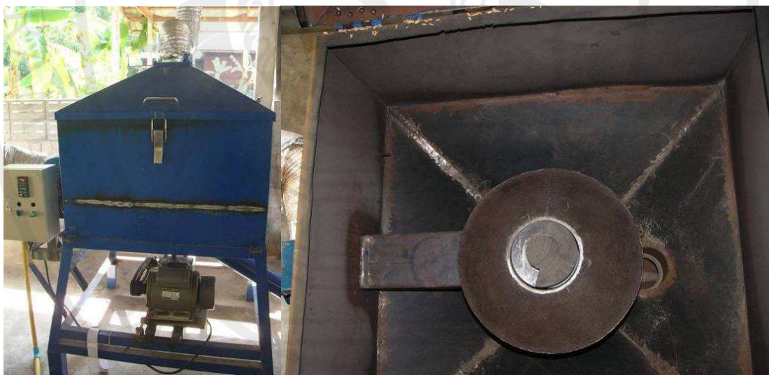
ภาพประกอบ 20 ติดตั้งเครื่องอบแห้งข้าวเปลือกแบบถังหมุนเวียน
