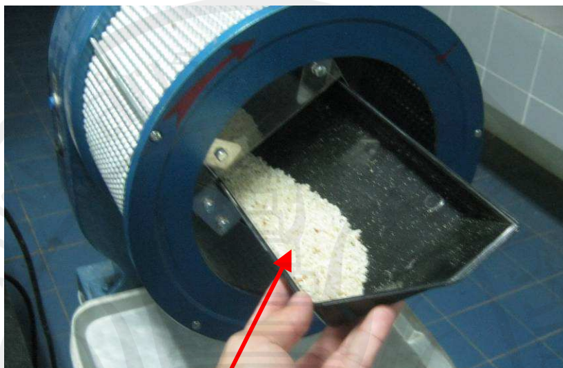
ภาพประกอบ 47 ขั้นตอนในการนำข้าวที่แตกหักถูกแยกออกเครื่อง หลังจากเครื่องหยุดการทำงาน
