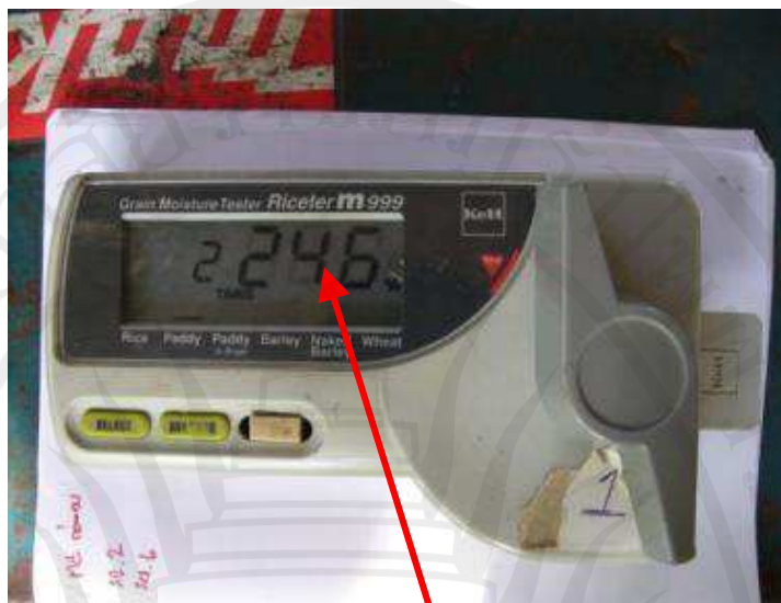
ภาพประกอบ 29 การวัดค่าความชื้นข้าวเปลือกก่อนอบและหลังอบซึ่งในมิเตอร์วัดค่าวัดได้ 24.6 %
