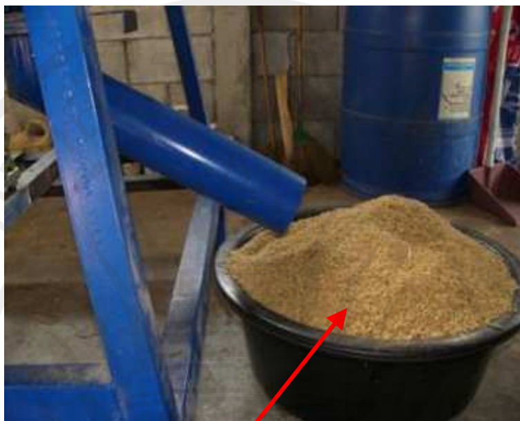
ภาพประกอบ 37 การระบายข้าวออกจากถังหลังจากอบข้าวเสร็จ
