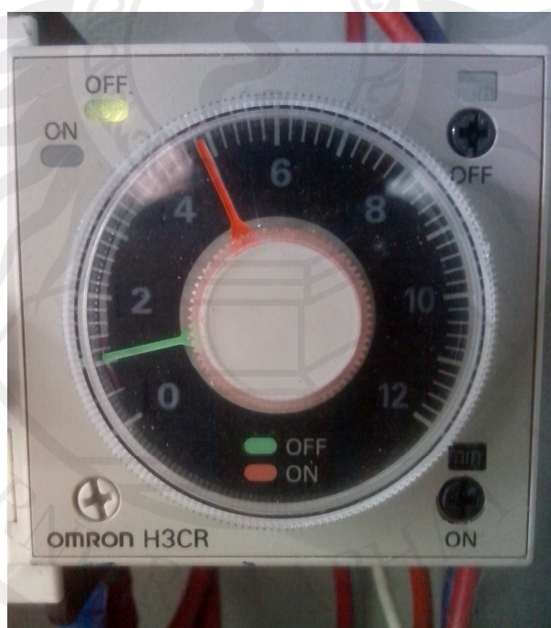
ภาพประกอบ 34 การตั้งอุปกรณ์ตัดต่อการทำงานของสกรู โดยตั้งทำงาน 5 นาทีและหยุดการทำงาน 1 นาที
