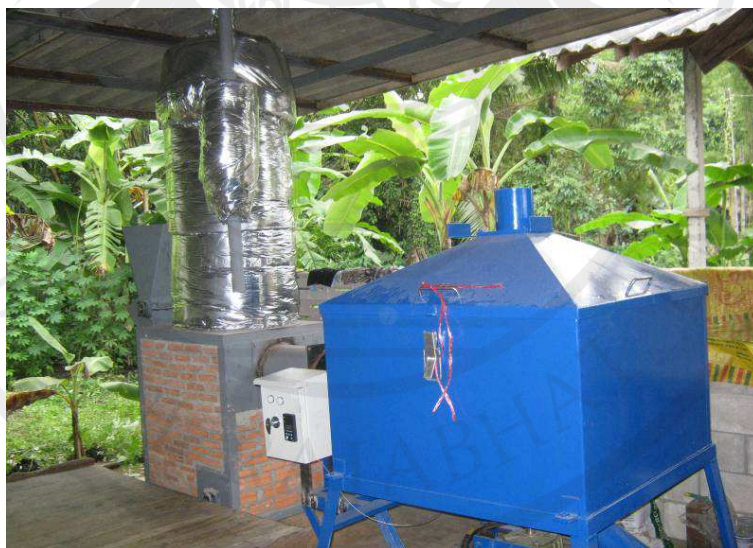
ภาพประกอบ 25 เชื่อมต่อเตาเผาเคลือบแบบเตาตะกรับผสมกับเตาแบบไซโคลนและเครื่องอบแห้งข้าวเปลือกแบบถ้งหมุนเวียน
