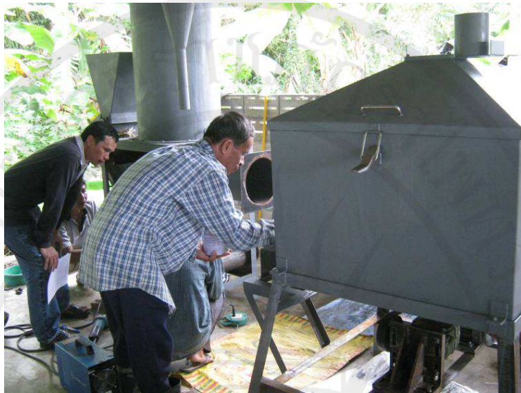
ภาพประกอบ 22 ติดตั้งอุปกรณ์เชื่อมต่อและทาสีรองพื้นของเครื่อง
