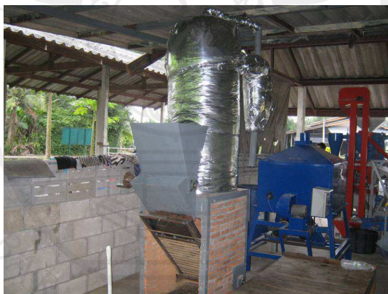
ภาพประกอบ 23 ตำแหน่งการติดตั้งก่อนเตาเผาเคลือบแบบเตาตะกรับผสมกับเตาแบบไซโคลนและเครื่องอบแห้งข้าวเปลือกแบบถังหมุนเวียน
