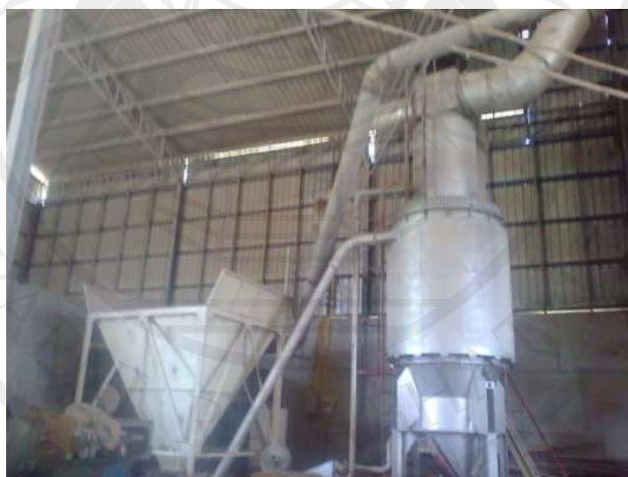
ภาพประกอบ 14 เตาศาแกลบแบบไซโคลน ที่มา : thephoenix99.com. ออนไลน์. ม.ป.ป.
