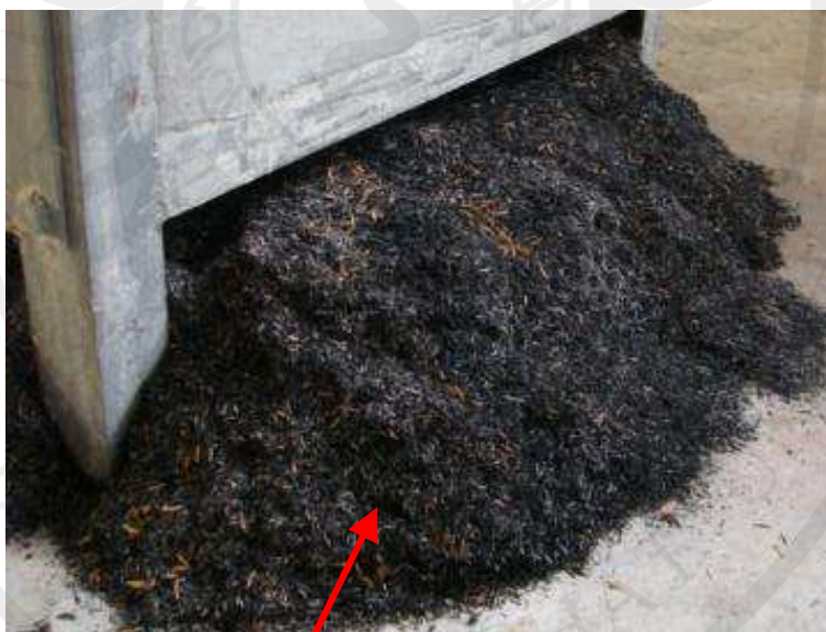
ภาพประกอบ 38 แกลบดำเหลือจากกระบวนการเผาแกลบใหม่
