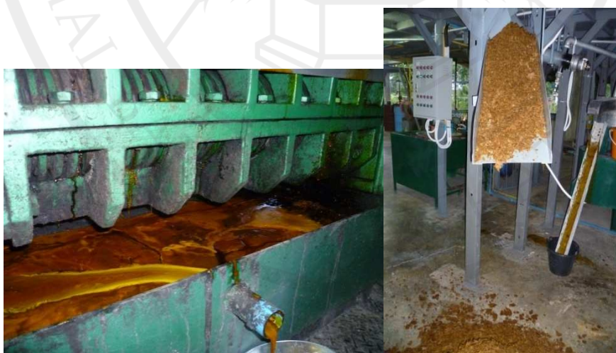
ภาพประกอบ 74 กระบวนการบีบสกัดน้ำมันจากผลปาล์มทอดสุก
