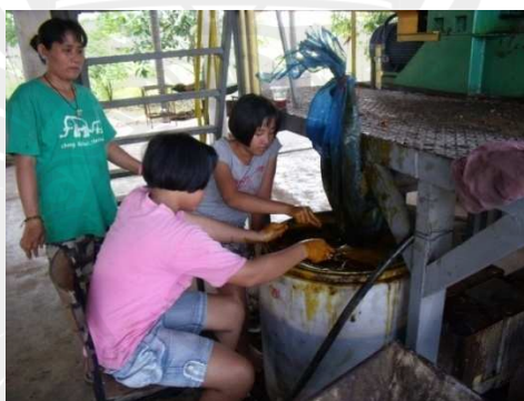
ภาพประกอบ 56 กรองน้ำมันปาล์มดิบด้วยตะแกรงกรอง
