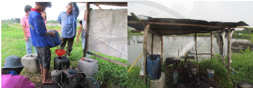
ภาพประกอบ 41 ทดลองใช้ไบโอดีเซล B100 กับเครื่องยนต์ดีเซลสำหรับดีนาในนาทุ่ง
