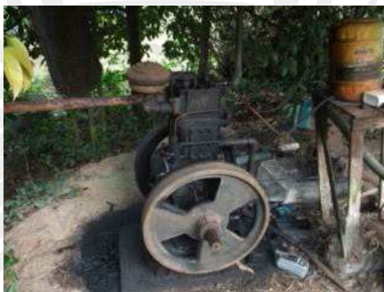
ภาพประกอบ 40 ทดลองใช้ไบโอดีเซล B100 กับเครื่องจักรสำหรับสูบน้ำ
