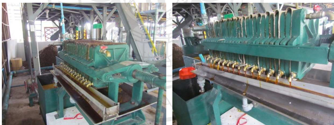
ภาพประกอบ 23 เครื่องกรองความดันสูง กรองแยกด้วยผ้ากรองความละเอียด 1 ไมครอน
