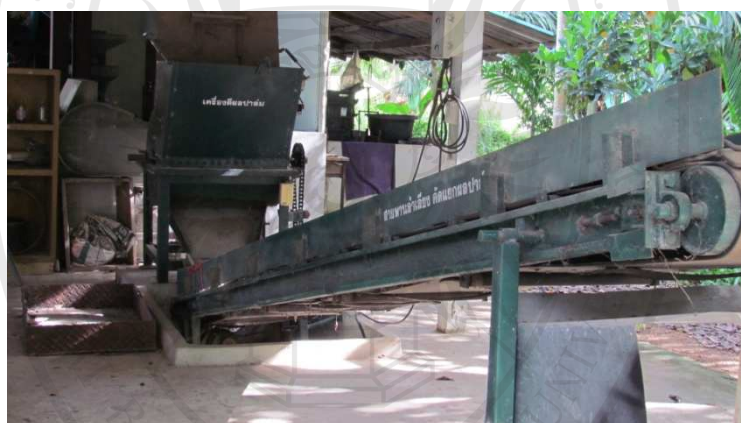
ภาพประกอบ 13 เครื่องตีแยกผลปาล์ม และสายพานลำเลียงคัดแยกผลปาล์ม
