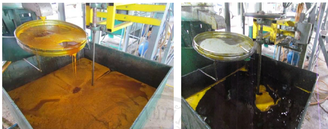
ภาพประกอบ 22 ถังเหล็กสี่เหลี่ยม ขนาดความจุ 450 ลิตร พร้อมติดตั้งระบบให้ความร้อนด้วย Heater ขนาด 3,000 วัตต์ และใบกวนน้ำมัน 50 รอบต่อนาที ด้วยระบบสายพานตรอบ
