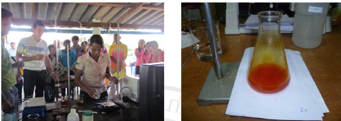
ภาพประกอบ 26 การไทเทรตเพื่อหาค่าร้อยละของกรดไขมันอิสระในน้ำมันปาล์มดิบ
