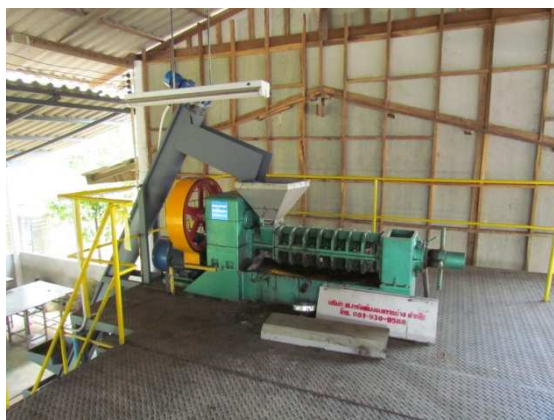
ภาพประกอบ 18 เครื่องหีบสกัดน้ำมันปาล์มดิบ
