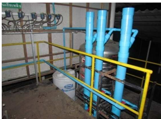
ภาพประกอบ 36 ระบบกรองเกลือแยกน้ำและความชื้นชุดที่ 2 หลังจากกรองแยกไขไบโอดีเซล
