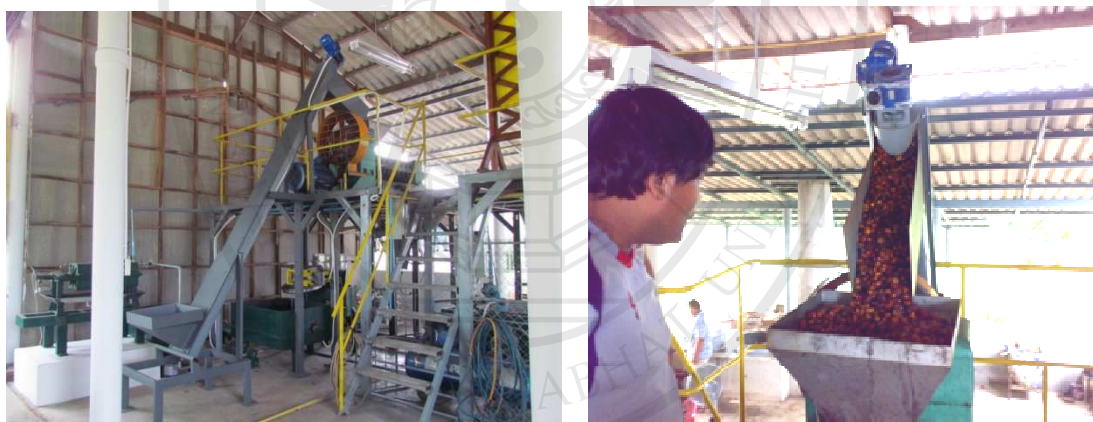
ภาพประกอบ 19 ท่อส่งลำเลียงผลปาล์มทอดสุกขึ้นสู่เครื่องหีบสกัดน้ำมันปาล์มดิบ
