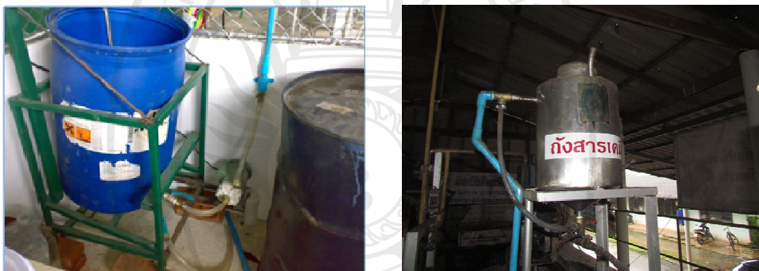
ภาพประกอบ 30 ระบบปั๊มเคมีขึ้นสู่ถังพักก่อนทำปฏิกิริยาไฮโอดีเซล
