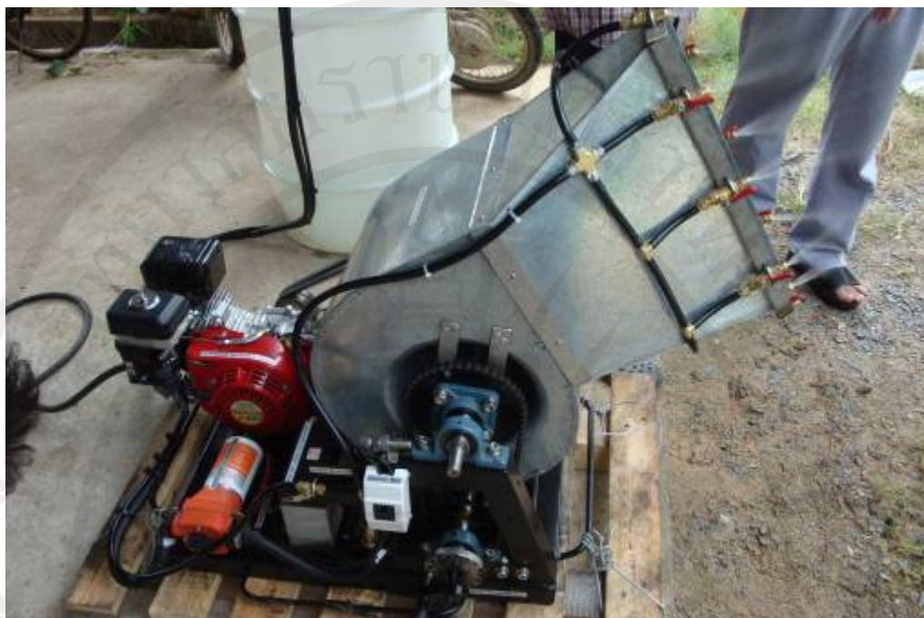
ภาพประกอบ 16 เครื่องฉีดพ่นสารเคมีแบบผสมกับอากาศติดตั้งกับจักรยานยนต์ฟ่งข้าง
