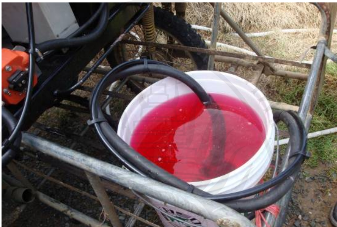
ภาพประกอบ 20 การผสมหมักพิมพ์เพื่อใช้ในการวัดขนาดและจำนวนละอองสารเคมี
