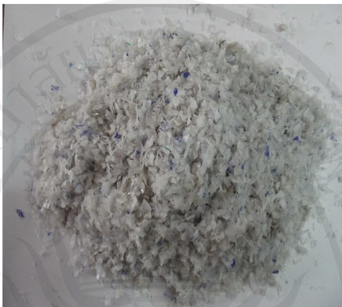
ภาพประกอบ 45 การย่อยพลาสติกชนิด Polyethylene, PE ที่ความเร็วรอบ 720 รอบต่อนาที
