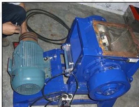
ภาพประกอบ 37 แสดงการประกอบมอเตอร์และสายพาน
