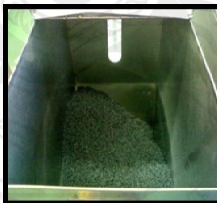
ภาพประกอบ 29 เครื่องผสมวัตถุดิบทำการตรวจสอบคุณภาพวัตถุดิบ ที่มา : บริษัท 687 พลาสติก แอนด์ โมลด์ จำกัด. 2555.
