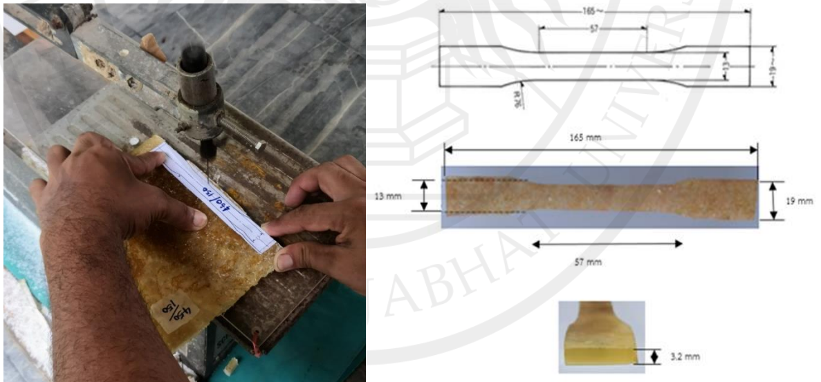
ภาพประกอบ 3.11 การตัดชิ้นงานไฟเบอร์กลาสตามมาตรฐาน ASTM D638
