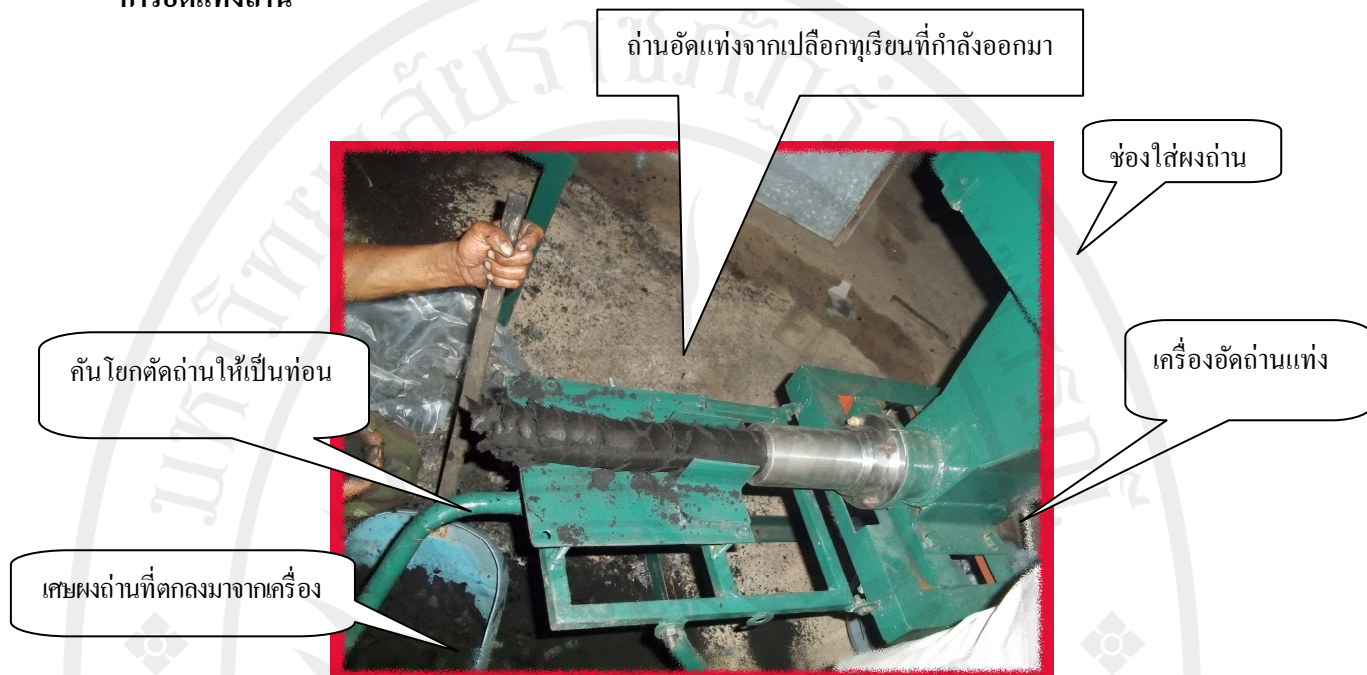
รูปภาพที่ 17 แสดงการอัดถ่านจากเปลือกทุเรียน
