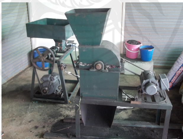
ภาพประกอบ 4 เครื่องย่อยเปลือกถ่านที่จัดทำมา
