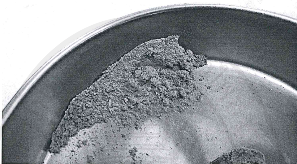
ภาพประกอบ 14 ลักษณะของเส้นใยเซลลูโลสที่ผ่านการบีบอัดและร้อนผ่านตะแกรง
