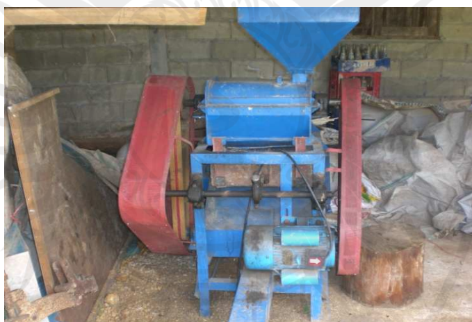
ภาพประกอบ 2 เครื่องสีข้าวต้นแบบก่อนพัฒนาที่ไม่มีไซโคลนดูดรำ
