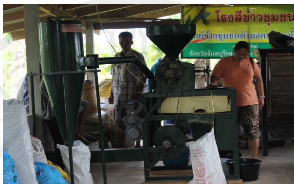
ภาพประกอบ 3 เครื่องสีข้าวที่ทำการพัฒนาแล้วทำการเพิ่มไซโคลนคูดร้า ที่มา : กลุ่มสมาชิกชาวนาตำบลตะปอน. ออนไลน์. 2555
