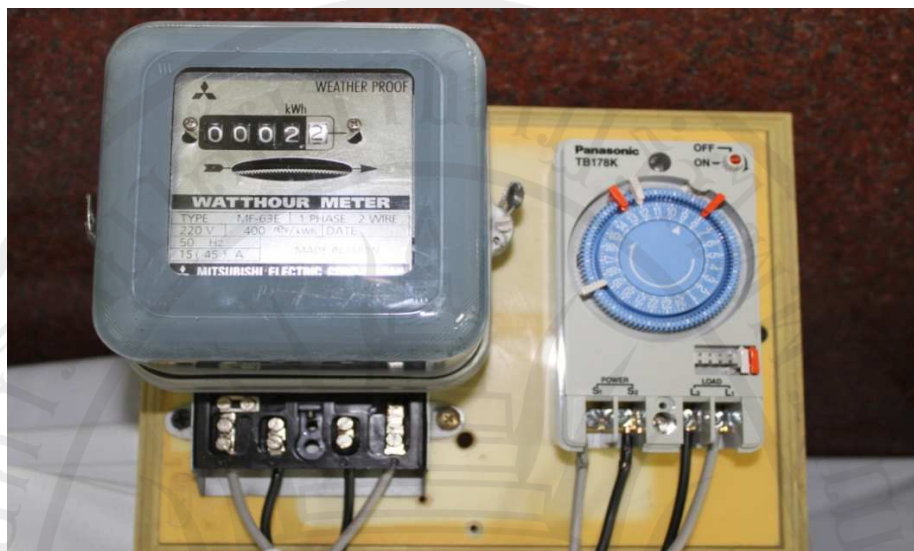
ภาพประกอบ 12 การใช้กิโลวัตต์ชั่วโมงมิเตอร์และเทอร์โมเมอร์สวิตช์ต่อเข้าในระบบปรับอากาศให้ทำงานโดยอัตโนมัติ
